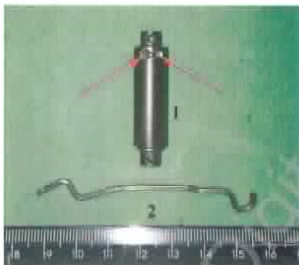
Figura 3 - 1: Eixo do registro de tiro e segurança de AQ, 2: Mola fixadora do eixo do registro de tiro e segurança. As setas indicam as duas cavidades-estágio que, quando pressionadas pela referida mola, servem para estabilizar o registro de tiro e segurança na posição escolhida ("S" ou "1").
